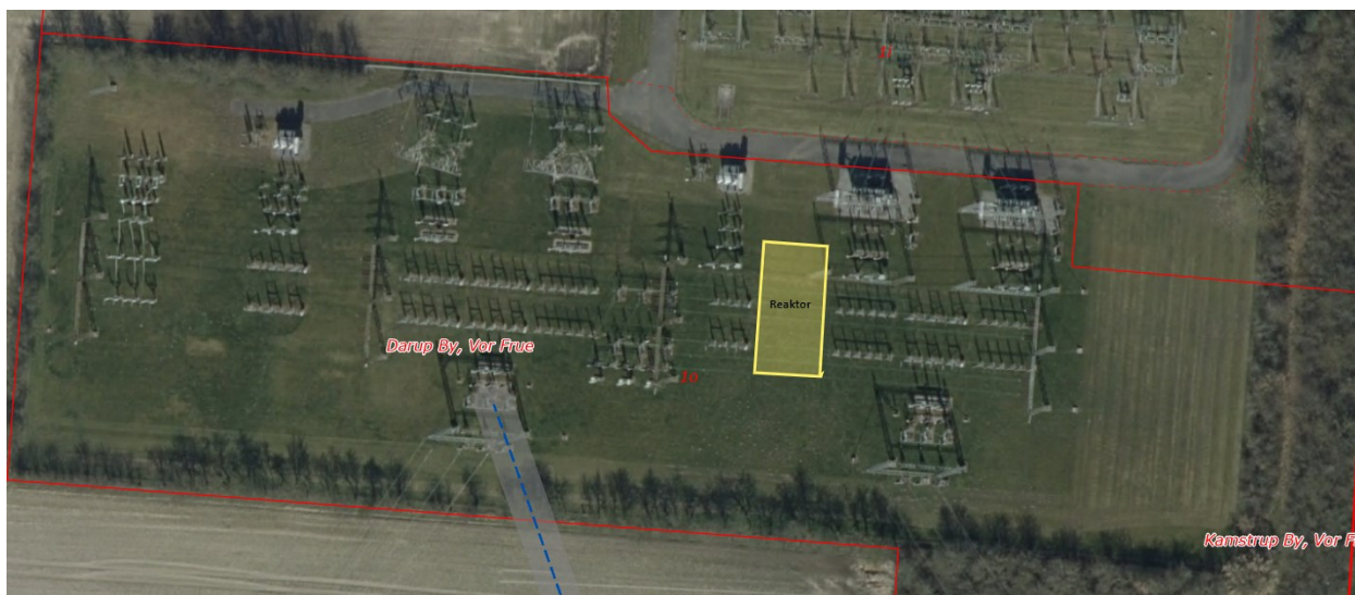
Figur 3.2. Anlægsaktiviteter KAM. Gul markering viser ny reaktor på station KAM. Blå stiplet linje viser kabelanlægget.
