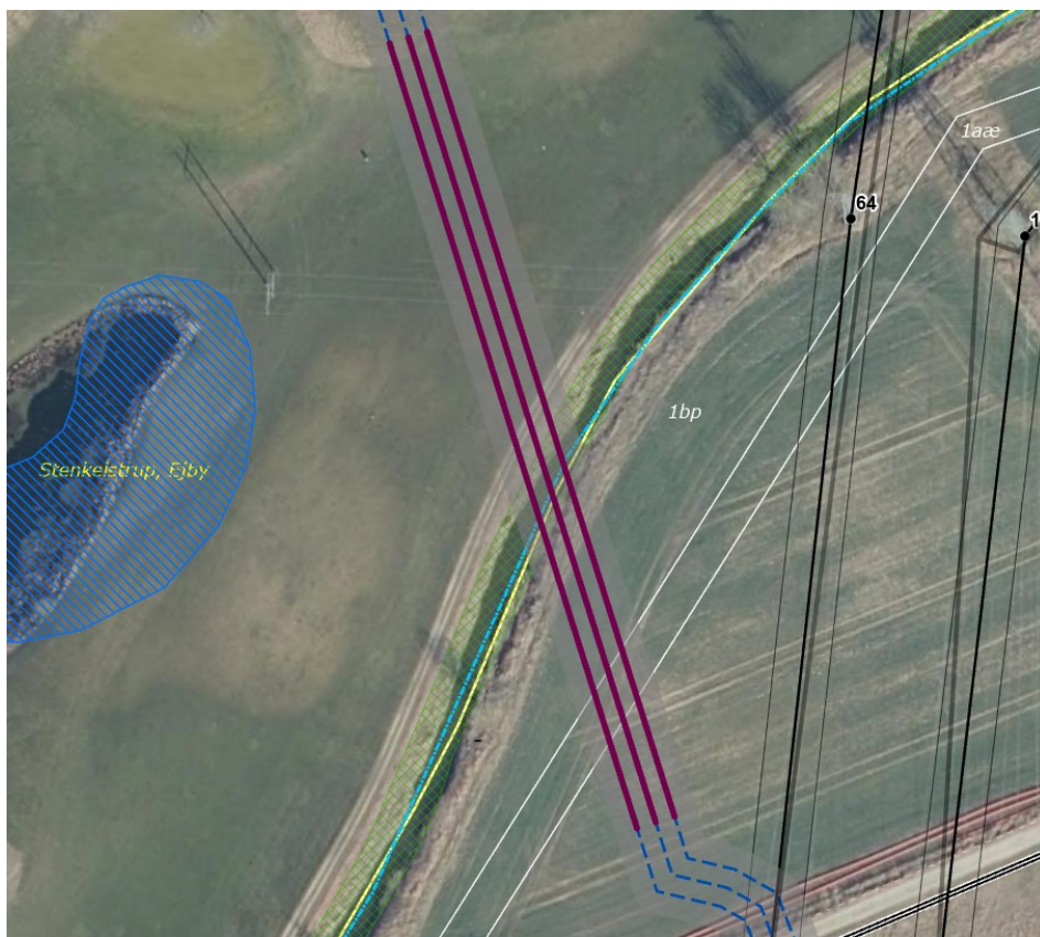
Figur 2.8. Kabelanlægget ved Habitatnatur, Køge Å.
