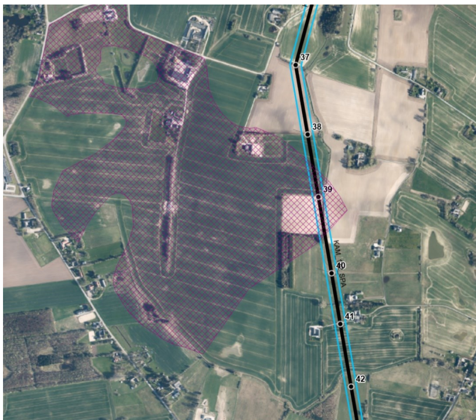
Figur 2.21. Placering af eksisterende 132 kV luftledning ift. udpeget interesseområde for råstoffer.
